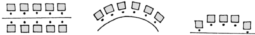
ภาพที่ 1: แสดงการจัดวางกลุ่มอาคารตามทิศทางของถนน
