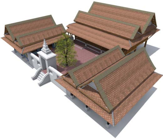
ภาพที่ 12: ภาพสามมิติที่แสดงตัวอย่าง "กุฏิเรือนหมู่" ตัวอย่างจากวัดท้ายยอ อำเภอเมืองฯ จังหวัดสงขลา ที่เป็นกุฏิหมู่ล้อมรอบลานกลาง โดยมีกุฏิประธานอยู่ ตรงกลาง และทางซ้าย และทางขวาคือกุฏิรอง
