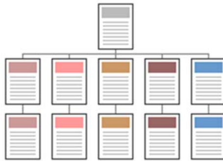
ภาพ 3: แสดงระบบโครงสร้างเว็บไซต์แบบ Hierarchical structure
